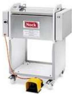
Шкуроеъемная машина открытого типа, предназначена для обесшкуривания рыбы. Великолепно приспособлена для обесшкуривания с маленькими потерями рыбы с тонкой кожей, например тилапия, форель, камбала, полосатая зубатка, каракатица и т.д.
